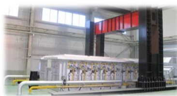
【大型水平加熱炉： \theta_{max}=1200^{\circ}\text{C} 】
