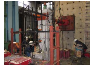
プレキャストPC橋脚の載荷試験
