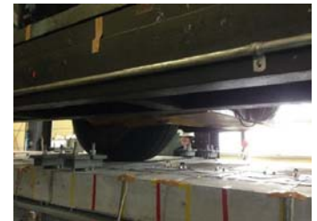
RC床版の輪荷重走行試験
