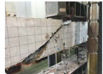
PC部材のせん断実験
