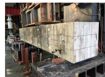
ASR損傷RC梁の載荷試験
