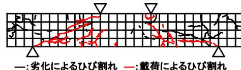
図7 実験供試体のひび割れ状況(複合劣化)
