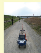
図-8 ランドストリーマー式高機動性表面波探査システム（応用地質社製）
