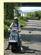
図-7 電気探査の発信機と受信アンテナからなる観測アレイをバイクで牽引している様子
