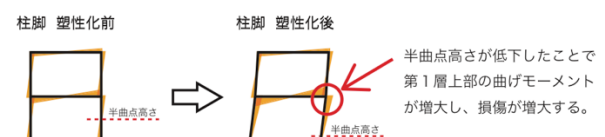
柱脚の塑性化による第1層上部の損傷集中
