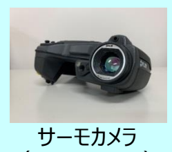
サーモカメラ (FLIR T440)
