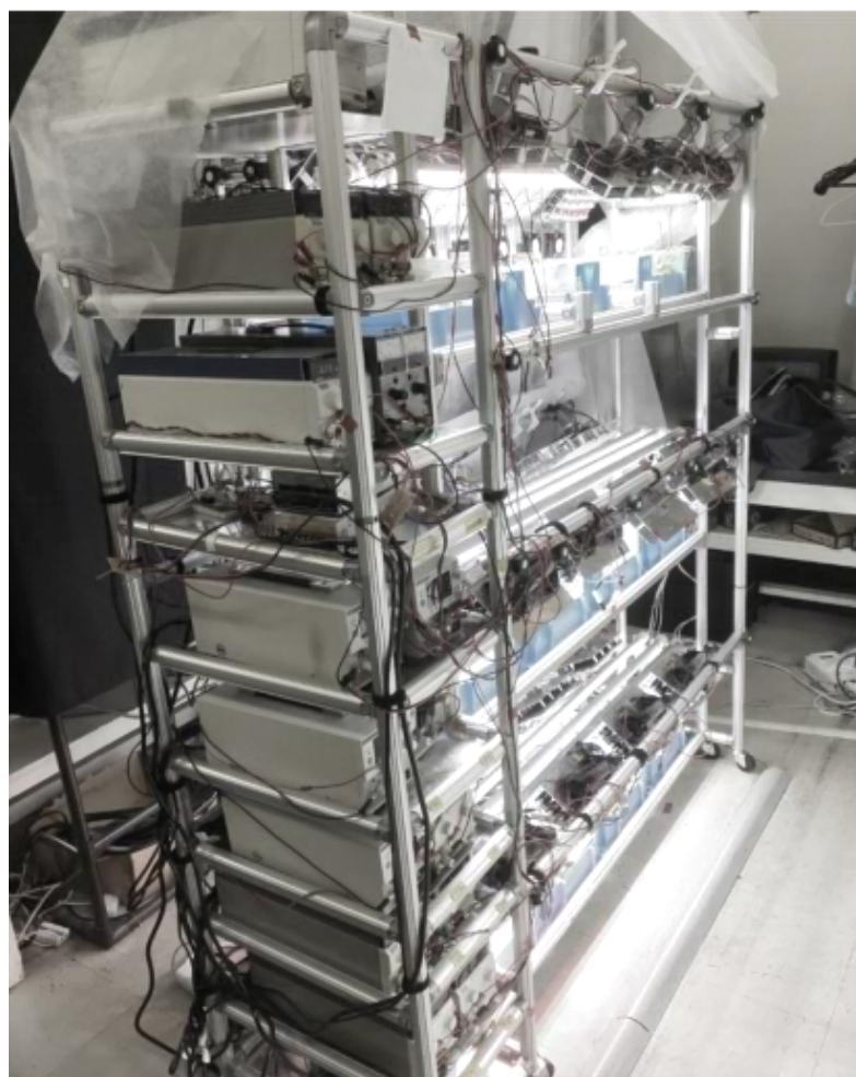
図1 六代目多色LED植物工場の例(水菜の水耕栽培方式3段x4棚)
