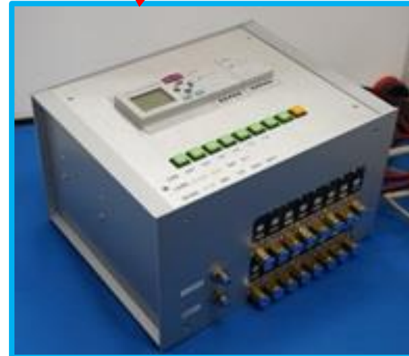
PLC駆動制御コントローラで シーケンス制御
